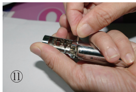
⑪ 爪楊枝を刺してもよいです、 印面部とピン穴部をあわせ ピンを通します
